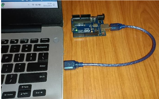
Gambar 2.2 Cara menghubungkan papan Arduino ke komputer
