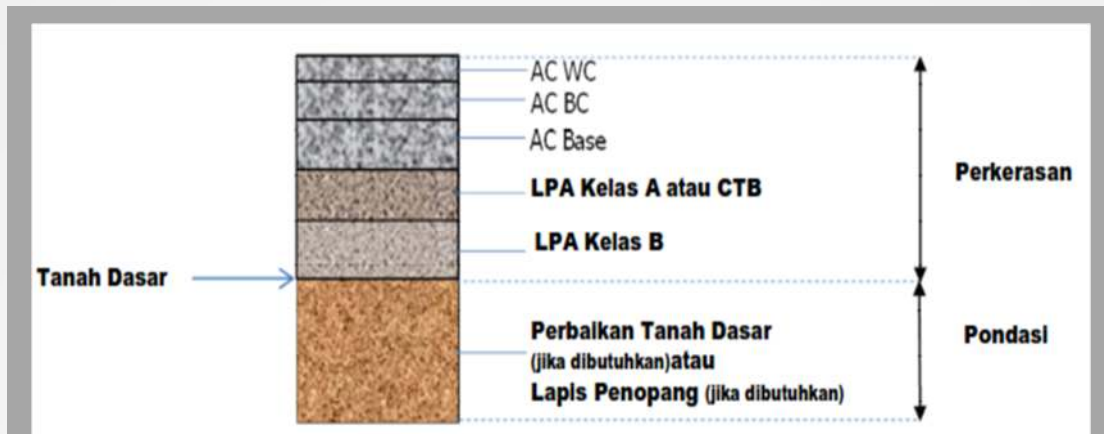
Gambar 5. Struktur Perkerasan Lentur (Lalu Lintas Berat) pada Permukaan Asli
