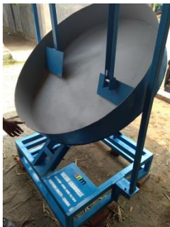
Gambar 13. Pan Granulator ukuran kecil dengan diameter pan 80cm
