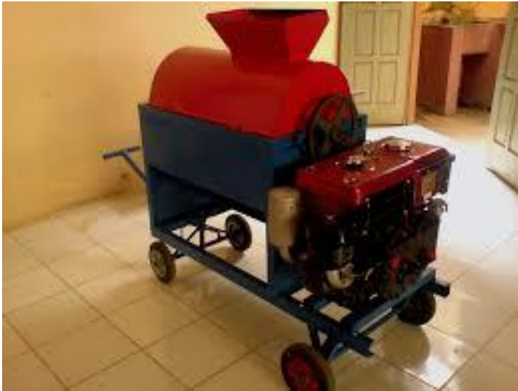
Gambar 14. Mesin cacah khusus untuk menghaluskan kompos atau pupuk kandang
